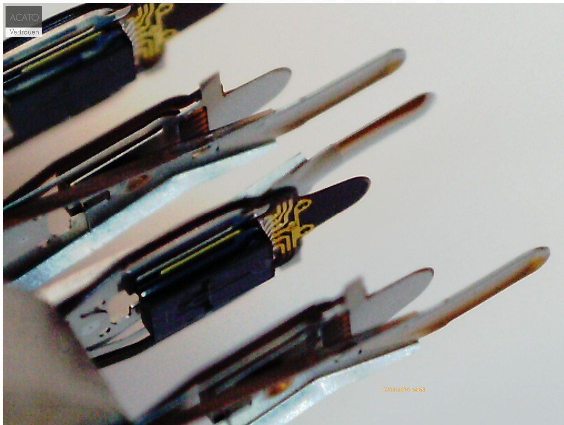
Beschädigte Leseköpfe einer Festplatte
